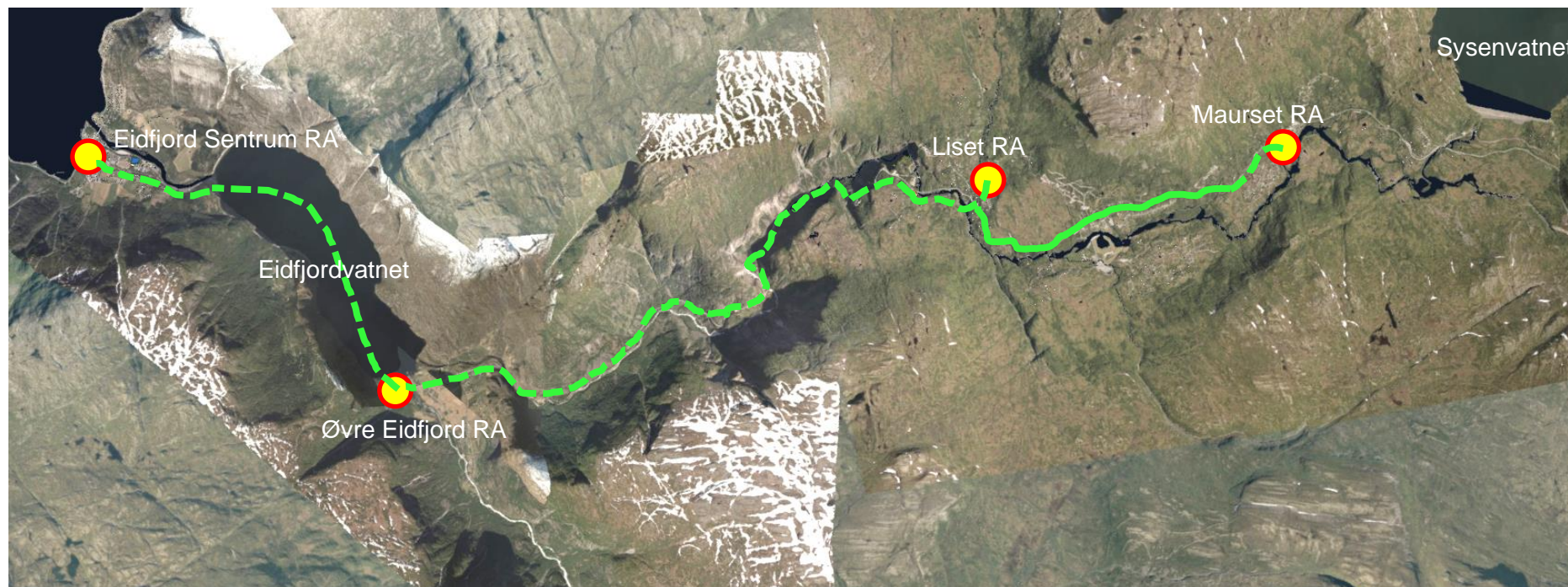
Figur 38 Ved etablering av et stort felles renseanlegg for Eidfjord sentrum, Øvre Eidfjord og Sysendalen vil det være nødvendig med 15,5 km nytt ledningsanlegg (stiplet grønn). Eksisterende ledningsanlegg er vist som heltrukken grønn linje. Ledningsanlegget i Eidfjordvatnet må i alle alternativer etableres, men i dette alternativet med en større dimensjon (pga. økte maksimale vannmengder). Fra sørenden av Eidfjordvatnet til Eidfjord sentrum må ledningsanlegget oppdimensjoneres.
