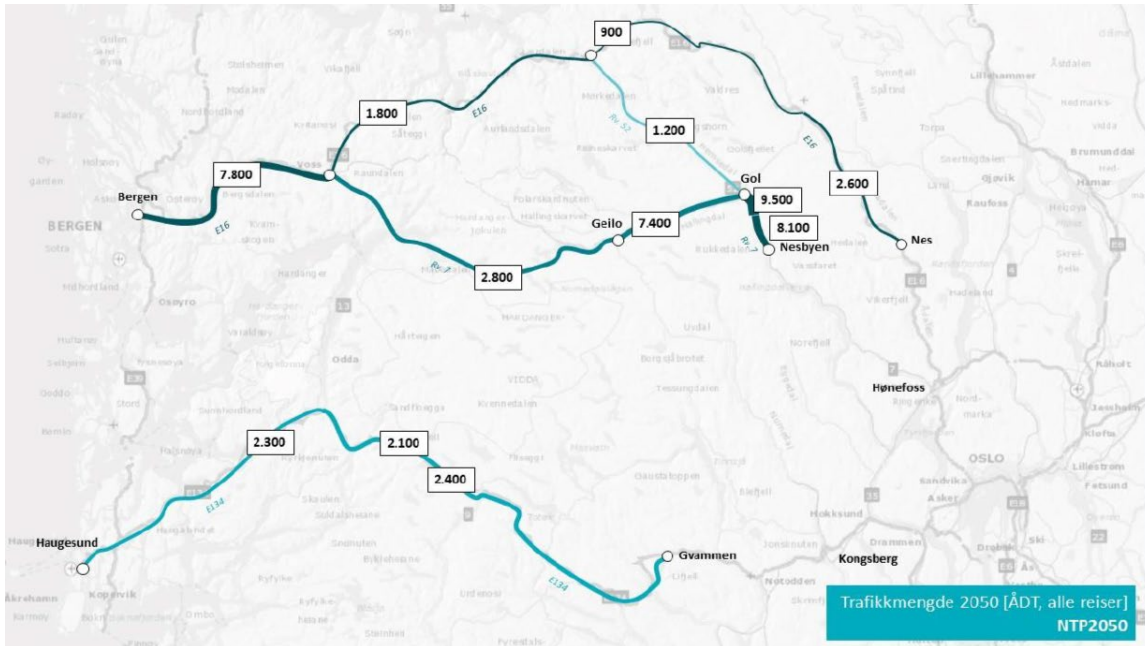
Trafikkmengde i 2050 (ÅDT, alle reiser) langs E134, E16, rv.7 og rv. 52 i Referansealternativet (NTP2050).
